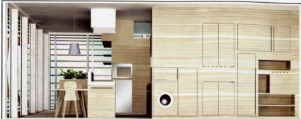
Rendering che rappresentano la suddivisione interna e la forma esterna della mini casa. Un cubo perfetto con copertura piatta per posizionare i pannelli solari, vetrate triple, tutte intorno, per il contenimento dei consumi e schermo in lamelle di legno. Per l'interno, uno spazio open con un'unica parete centrale intorno alla quale ruotano le varie zone: cucina e living da un lato, bagno e notte dall'altro.
